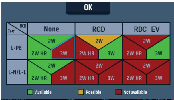
Fig. 54: Tabla de orientación para medidas de bucle
