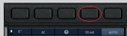
5. Pulse repetidamente la tecla de acceso directo 5 hasta que aparezca la medida de tensión de contacto (Touch V).
