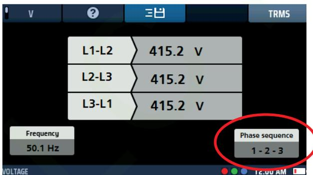
Fig. 39: Rotación de fase de tensión
