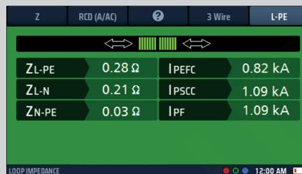
**NOTA:** Las opciones de 2 hilos y 3 hilos se pueden usar para medir la impedancia de bucle en un circuito protegido por un RCD Tipo B de 30 mA. Si el circuito contiene un RDC de 6 mA que protege un RCD Tipo A de 30 mA, se necesitarán 3 conexiones y se debe seleccionar la configuración RDC EV.
