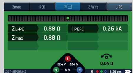
11. Vuelva a conectar el equipo en el siguiente punto en el que desee medir el valor de Zmax. Si está activado AUTO START (Inicio automático) en la configuración pulse el botón de medir ANTES de conectar los cables de medida.
