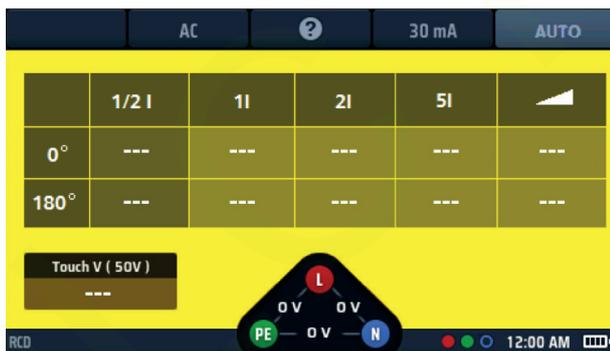
Fig. 48: Ejemplo de pantalla de inicio de medida automática de RCD
