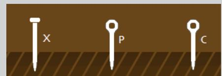
6. Conecte un cable de medida en la toma verde y conéctelo al electrodo en el que va a efectuarse la medida.
