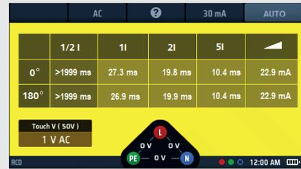
Fig. 49: Progreso del resultado de la medida AUTO (Automática) de RCD
