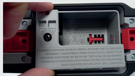
7. Sustituya el fusible fundido por uno nuevo del tipo correcto que se indica en la especificación .
