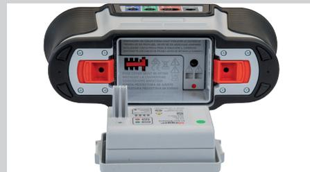
5. Desatornille el tornillo de la base del compartimento de la batería.
