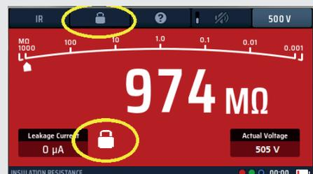
**Fig. 23:** Bloqueo de medida de aislamiento
