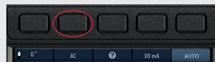
4. Pulse repetidamente la tecla de acceso directo 4 hasta que se indique la corriente nominal del RCD en el que vaya a efectuar la medición.
